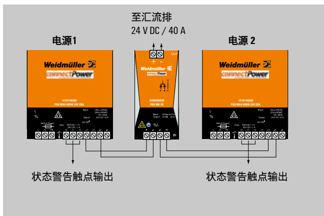
图(4)两台40 A电源并联
