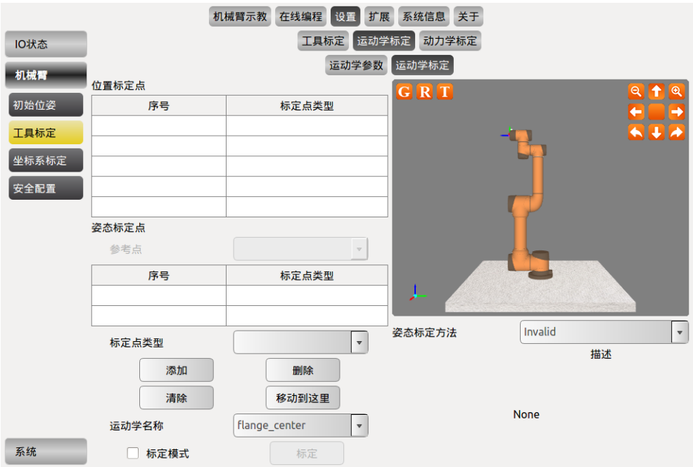
图 10-27 运动学工具标定
