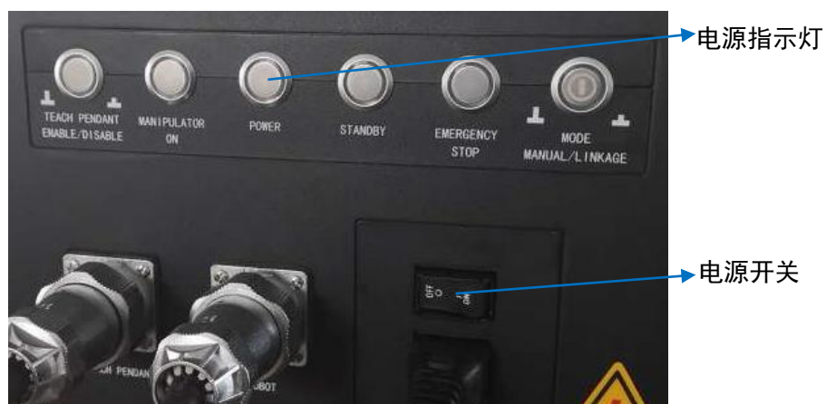
图 9-1 控制柜电源开关及指示灯示意图
