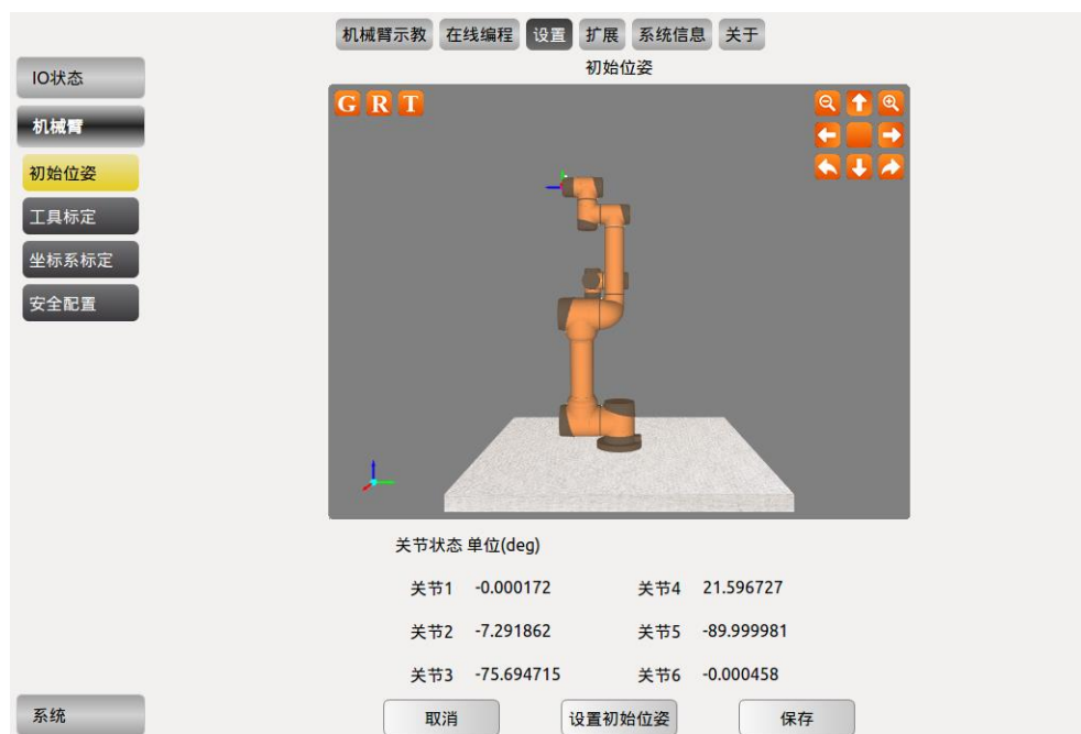
图 10-26 机器人初始位姿设置
