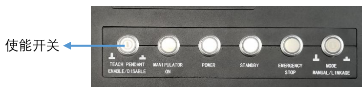
图 7-8 示教器使能开关位置
