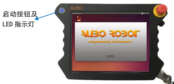
图 9-2 示教器启动按钮及 LED 上电指示灯示意图
