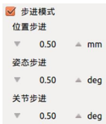
图 10-8 步进模式示意图
