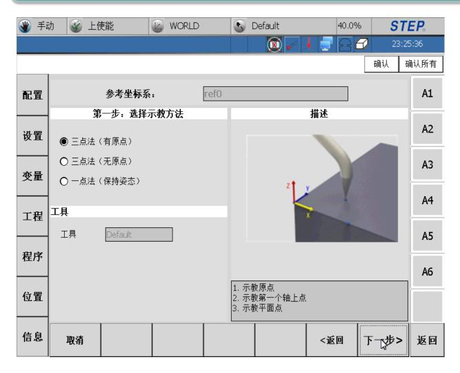
1,按下示教器的变量 按键,在弹出的目录里 选择"坐标系",进入 坐标系示教界面 2,在参考坐标系示教 界面选择要示教的坐标 系和参考的基准坐标系, 点击设置, 进入参考坐 标系示教方法选择界面, 3,参考坐标系的示教 方法有三种:有原点三 点法、无原点三点法和 保持姿态的一点法。用 户可以根据自己的需求 选择示教方法。
