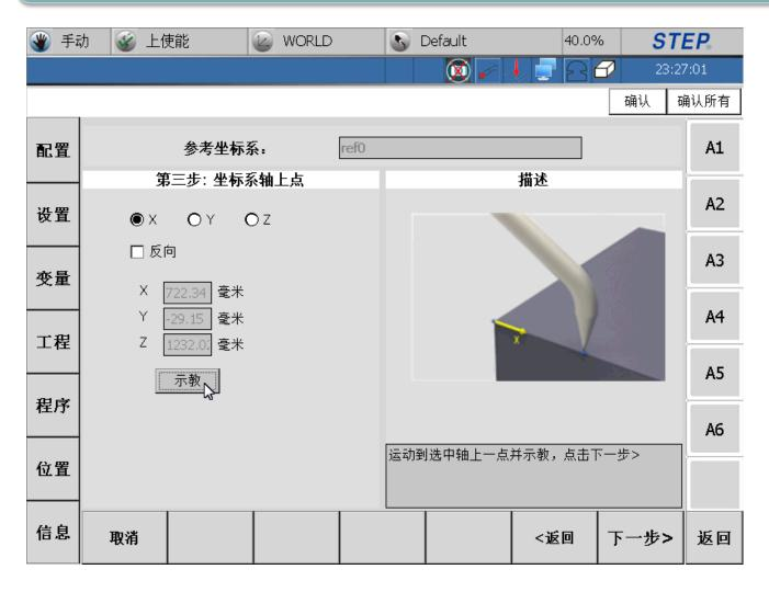
点击下一步, 进入到第二 个位置点的 示教界面, 如下图所示, 可以选择示 教点所在的 轴和方向, 然后将机器 人移动到选 中轴上示教
