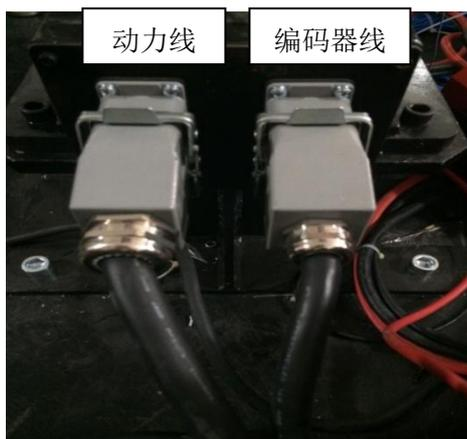
(a) 连接到机器人本体的线缆
