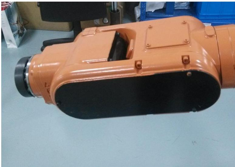
图 1.5 SA1400 的 5, 6 轴电机在内部
