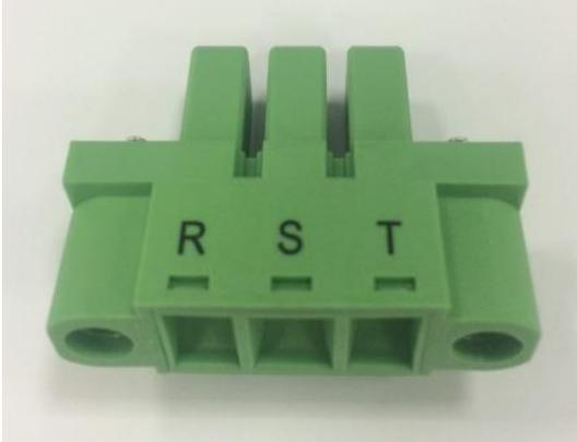
圖 3-3 主迴路電路電源接頭實體圖
