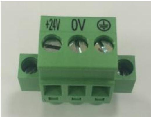
圖 3-5 控制電路電源接頭實體圖
