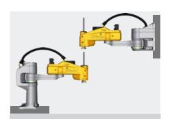
多种安装方式 置地式或壁挂式安装使得机器人集成更具适应 性和灵活性。
