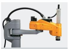
IP54 保护等级, 角形板设计和波纹管能更好地 防止灰尘和液体。
