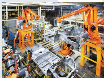
点焊机器人/大型搬运机器人 实现高生产效率
